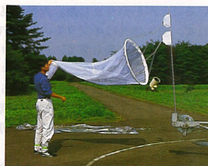
写真3—係留ロープに固定して揚げられる捕虫ネット
