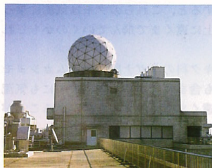
写真1—茨城県つくば市にある気象研究所のドップラー気象レーダー
