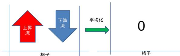
低解像度のモデルでは、上昇流と下降流が打ち消しあって、鉛直速度はゼロになってしまう。
