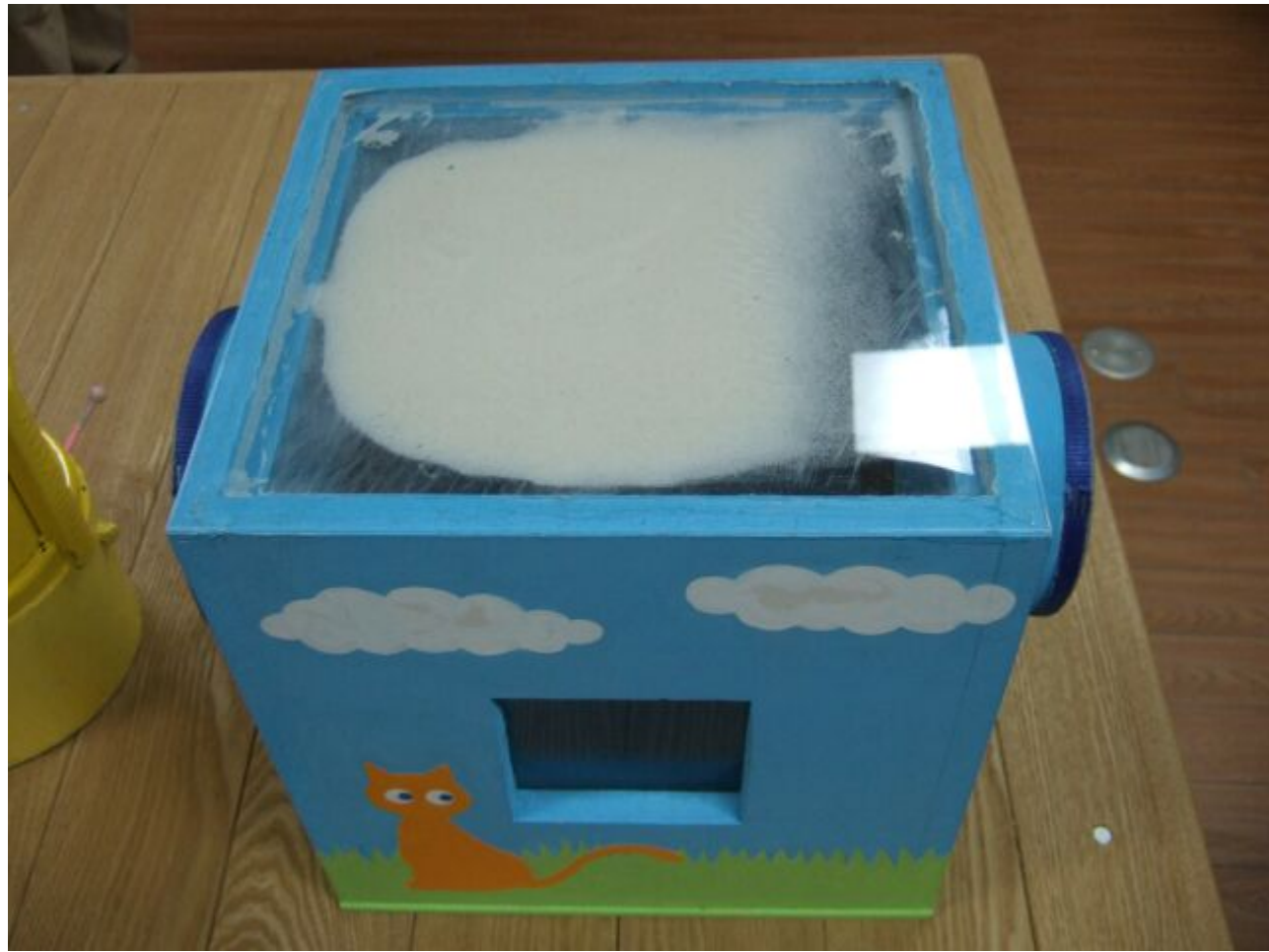
両サイドの太鼓を叩くと砂が踊ってパターン形成します。（設計：阪口 秀、製作：鬼工房）
