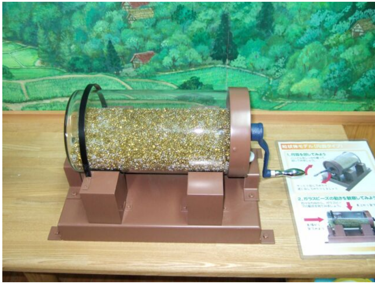
回転速度によって種々の3次元的な偏析パターンが出る
